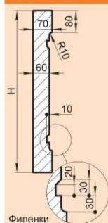
Филенки состоят из наборных элементов и могут иметь различную длину.
