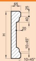
Филенки состоят из наборных элементов и могут иметь различную длину.
